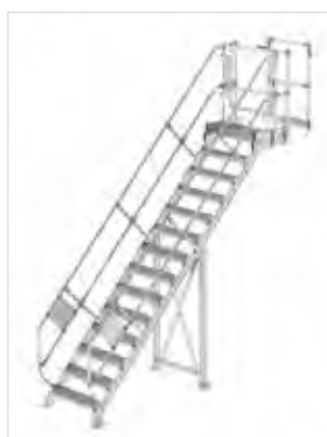
Модуль 4 Лестница 45°, с платформой, самозакрывающейся защитной дверью и перилами.
