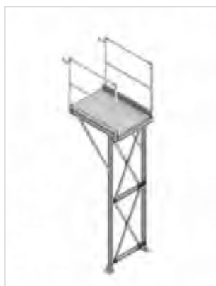
Модуль 1 Длина платформы 1270 мм.
