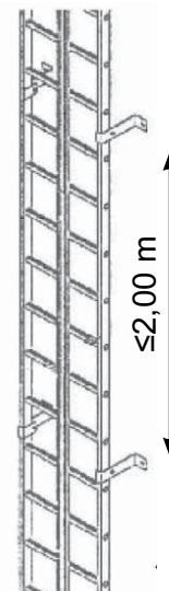
Abb. 5 Steigschutzschiene an den Sprossen einer Steigleiter bzw. Schachtleiter montiert.
